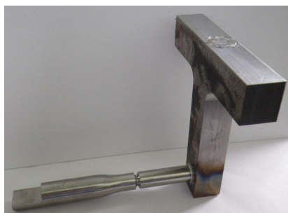
FIGURE D.1 – Éprouvette dans la configuration pour solliciter le deuxième mode propre de la structure. Méplat perpendiculaire au plan de symétrie de la masselotte
