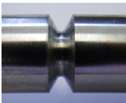
(a) Photo de l'entaille sur un éprouvette avant essai
