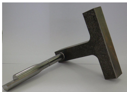
FIGURE D.2 – Éprouvette dans la configuration pour solliciter le premier et / ou le troisième mode propre de la structure. Méplat parallèle au plan de symétrie de la masselotte
