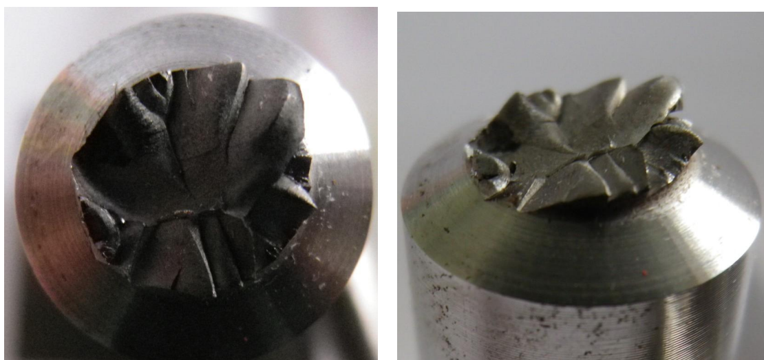
(a) Faciès de rupture d'une éprouvette après démon- (b) Faciès de rupture d'une éprouvette après démon- tage (de face) tage (de profil)
