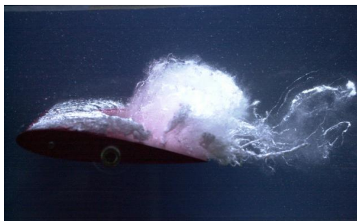
Figure 2-2 : Cavitation dans un hydrofoil NACA 0015 [16]
