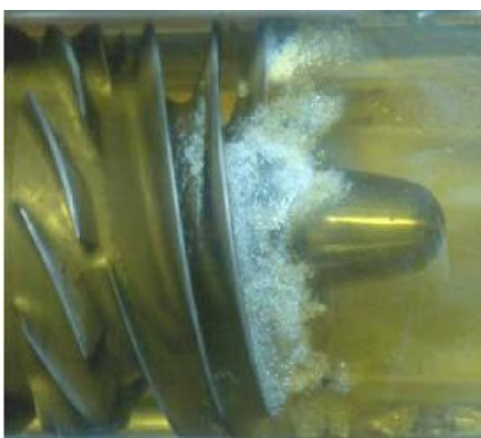
Figure 1-1 : Cavitation dans l'étage d'aspiration d'une pompe spatiale (inducteur) [1]
